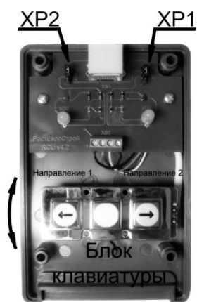
Вид ПДУ со снятой крышкой
