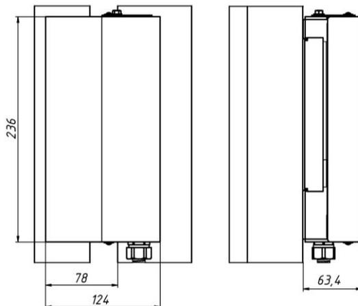
Рисунок 5 - Габариты комплекта в проеме двери
